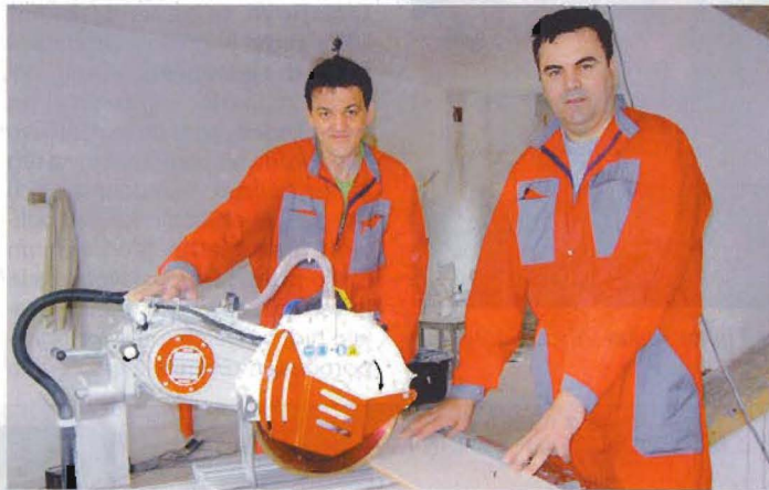
Bojan Špacapan (levo) in Štefan Kralj (desno) pri delu s strojem za vodni izrez keramike, vseh vrst kamnov ter raznih steklenih in navadnih mozaikov
